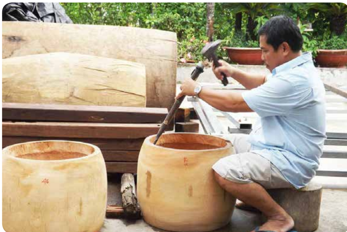
Bước 1: Đục gỗ để làm tang trống
