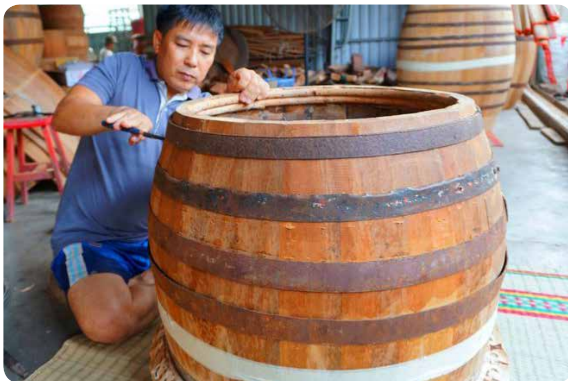
Bước 2: Xử lý phần khung khổ cho tròn, đều...
