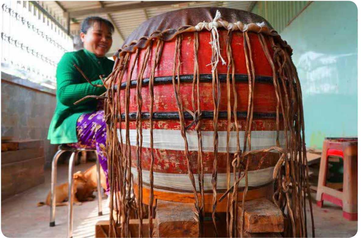
Bước 4: Căng dây, phủ da lên mặt trống
