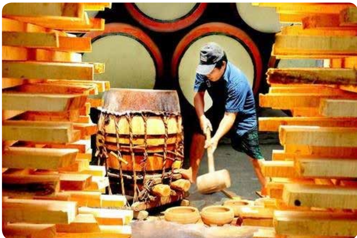
Căng mặt trống bằng con nôm
